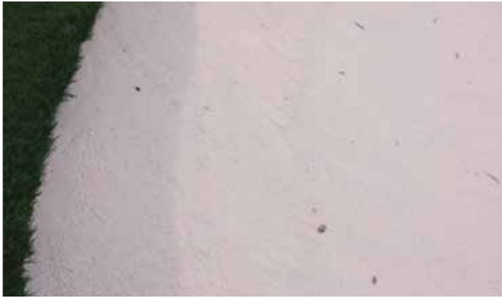
Feuchtigkeit, die bei steilen Wänden bei Trockenheit durch Capillary Concrete eingebracht wird. Foto 10 Minuten nach Zyklusbeginn.
